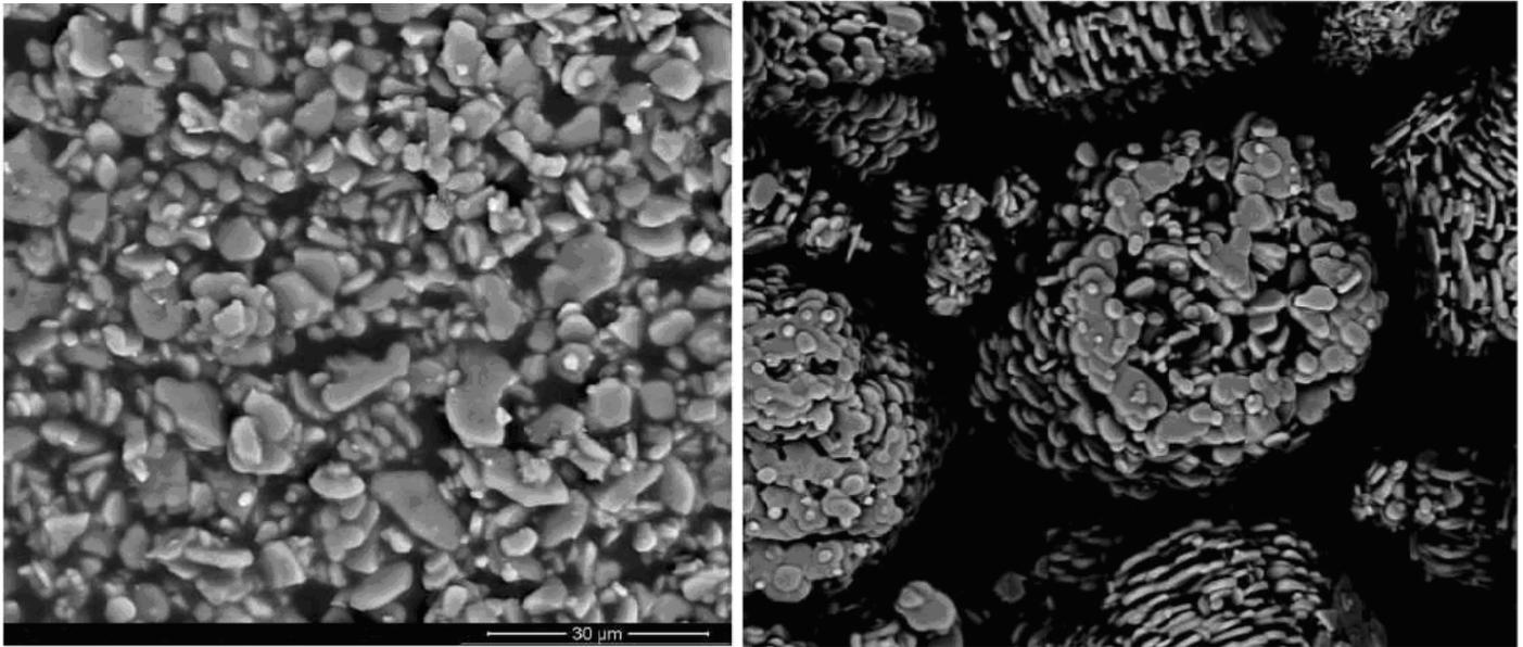
Под сканирующим электронным микроскопом кальцинированные зерна оксида алюминия выглядят в виде свай или агломератов кристаллитов  $\alpha\text{-Al}_2\text{O}_3$ , средний размер которых может варьироваться от 0,5 до 10 мкм в зависимости от температуры прокаливания, продолжительности прокаливания и природы минерализатора. В основном производят следующие виды кальцинированного глинозема
